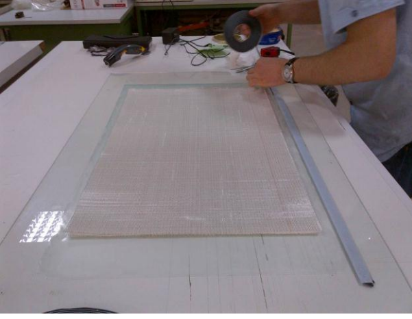
Şekil 3. Kağıt bantların sökölüp sealing tape'lerin yapıştırılması
