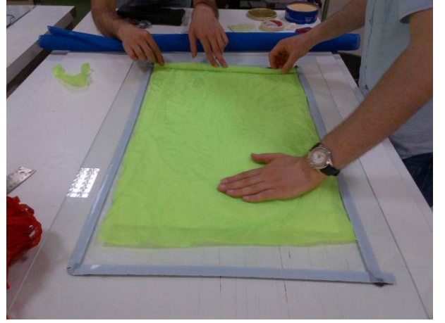
Şekil 5. Spiral hortumun peel ply ile sarılarak iyice yerleştirilmesi
