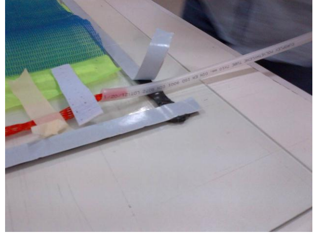
Şekil 9. “Kırmızı file”nin vakum hortumuna yerleştirilişi
